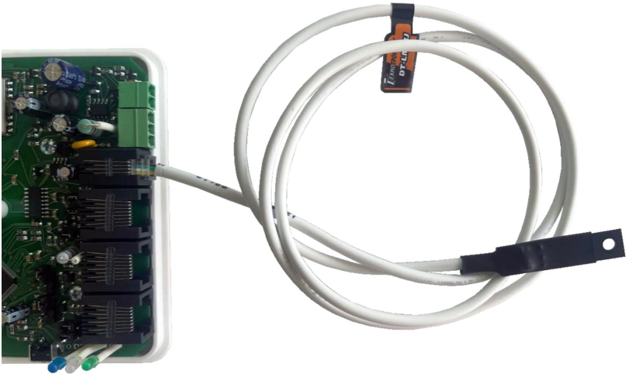
Способ подключения DT-LM-RJ к контроллеру
