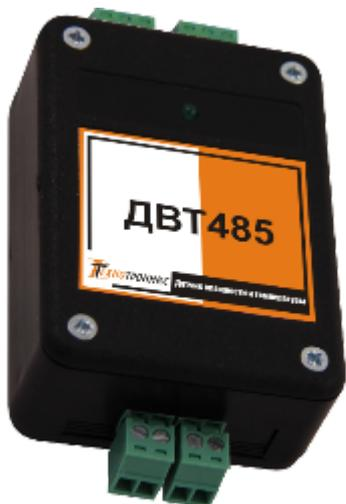
ДВТ485 предназначен для измерения относительной влажности (в процентах) и температуры в одной произвольной точке. Диапазон измерения температуры – -55 до +75 °С, с точностью  $\pm 1$  °С. Диапазон измерения относительной влажности – 20%-90%, с точностью  $\pm 5\%$ .
