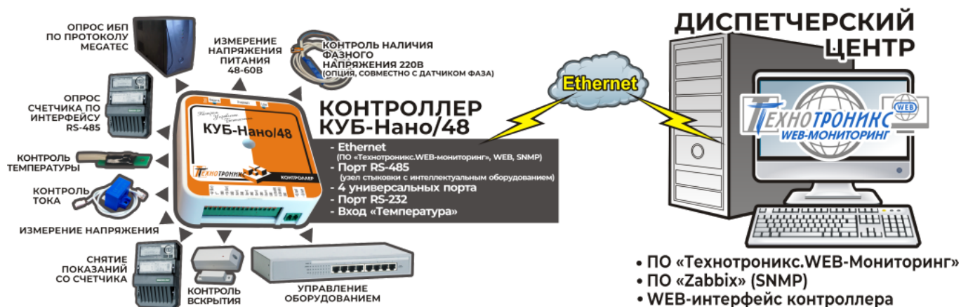
Рис.1. Функциональные возможности контроллера КУБ-Нано/48
